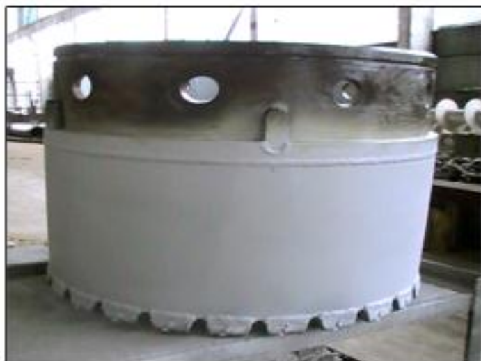
Коронка буровая с зубом типа WS
